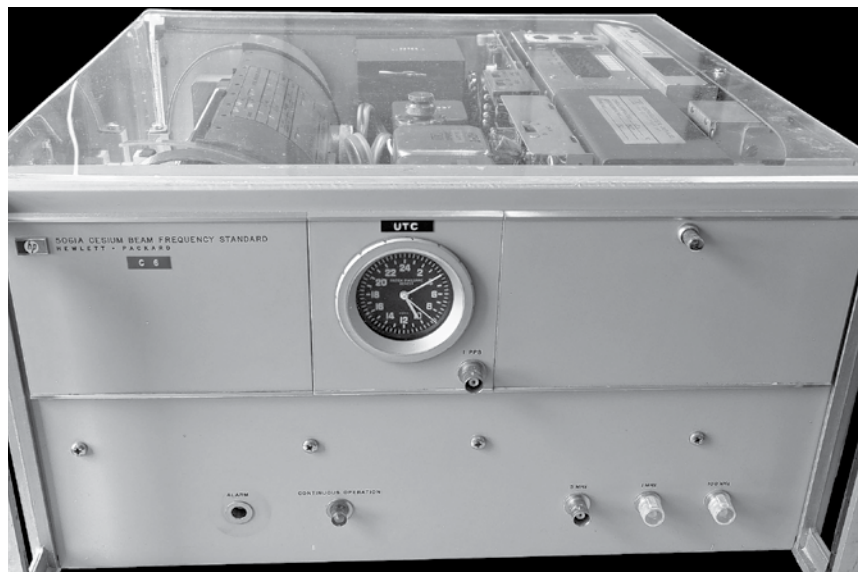
Die modernste Uhr der Sonderausstellung: Atomuhr der PTB, gefertigt von HP in Böblingen
