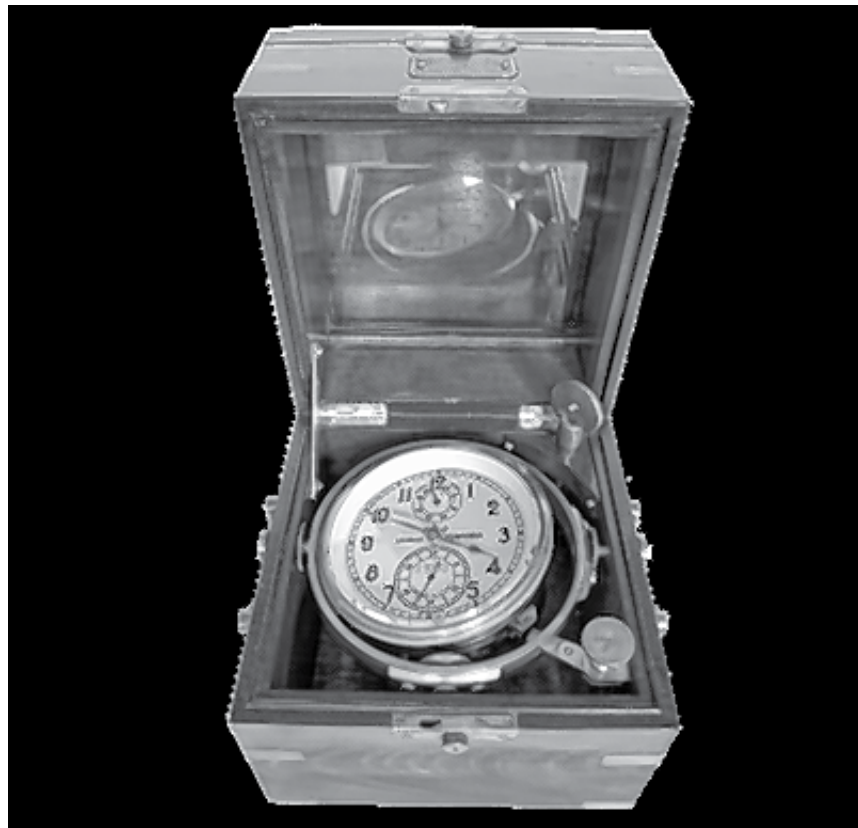
Die am weitesten gereiste Uhr: Marinechronometer Nr. 21003 mit Gangreserve Erste Moskauer Uhrenfabrik, Kirov ca. 1970 – 1980
